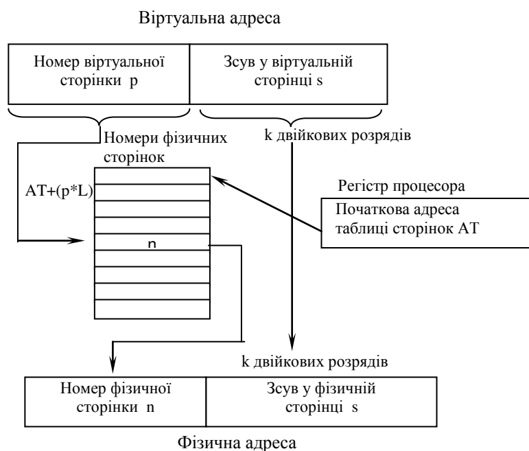
Рис. 3.6 – Перетворення адреси при сторінковому розподілі пам'яті
